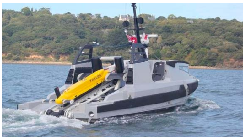
Prototype de navire autonome (USV) de la société britannique ASV et sonar remorqué de Thales UK pour le programme MMCM.
